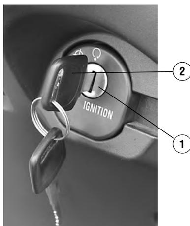
1. Замок включения/выключения электротрицикла.
